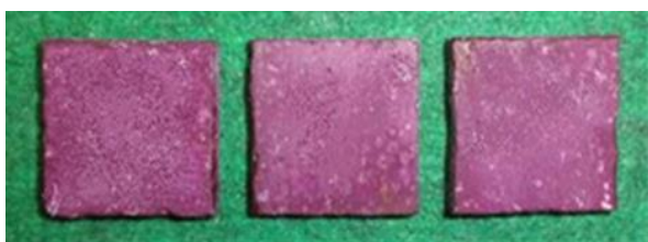
Photo 4 促進期間 52 週の中酸化深さの状況(n=3) Accelerated Carbonation Depth (52weeks:n=3)
