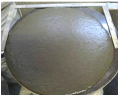
Photo 2 モルタルフロー Mortar Flow
