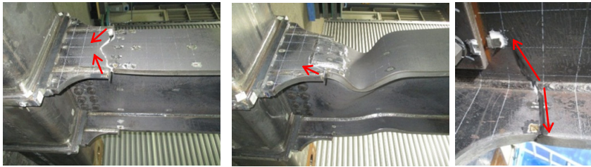
(a) CH: ハンチ先端のき裂・破断 (b) LB: 局部座屈 (c) CW: ウェブ溶接部のき裂・破断
