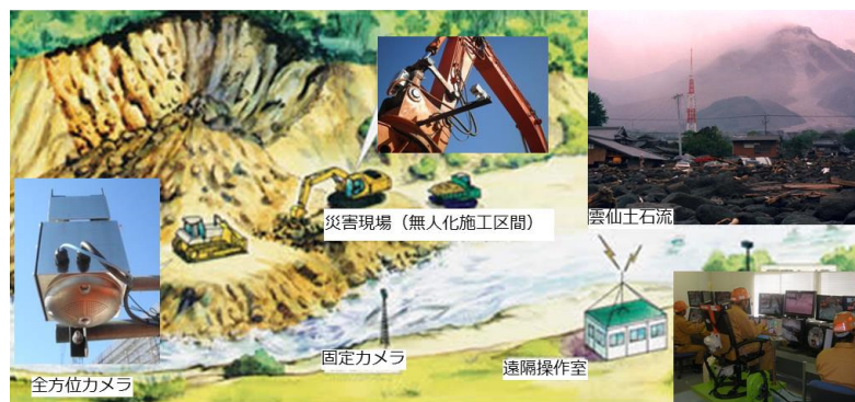
Fig. 15 無人化施工技術 Remote-Controlled Machinery System
