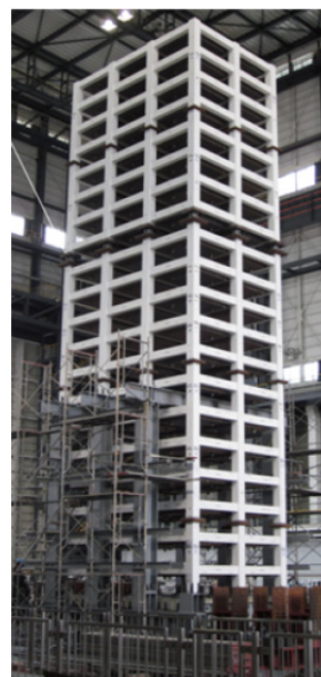
Photo 15 長周期地震動対策として行われた 20 層 RC 造建物試験体の振動台実験 Shaking Table Test of 20-Stories RC Building Specimen
