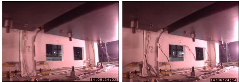
Photo 3 #3-5加振時のX1構面2階雑壁の損傷 (左:衝突直前, 右:直後)
