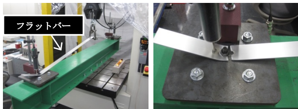
(a) 加力後 [全景] (b) 加力後 [破断部詳細]
