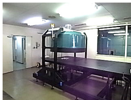
Photo 1 喜々津ら 18, 19) による開放型の実験装置 Open Type Tornado Simulator by Kikitsu et al.
