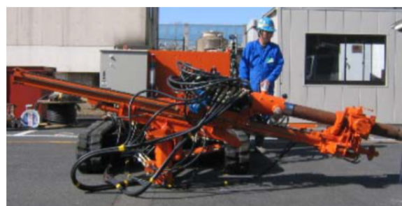
Photo 1 ハイスペックネイリング工法専用機械 (h=1.1m) Machine of “High Spec Nailing”
