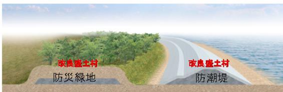
Fig. 1 石炭灰改良材の土木分野への利用例
