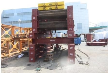
Photo 3 実験状況 (押し込み载荷試験, 砂礫地盤)
