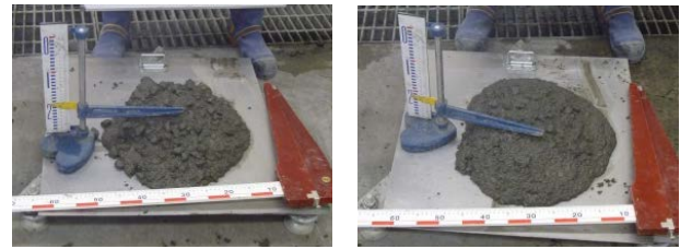
通常の重量コンクリート (SL18cm) フローアップクリート (SL10cm→21cm)
