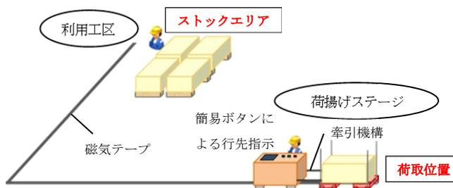
Fig. 1 牽引型水平搬送システムの基本構成
