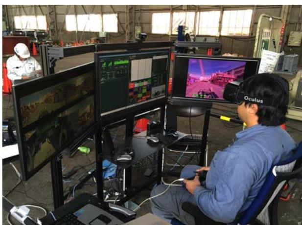
Photo 7 遠隔操縦の状況(操縦席)
