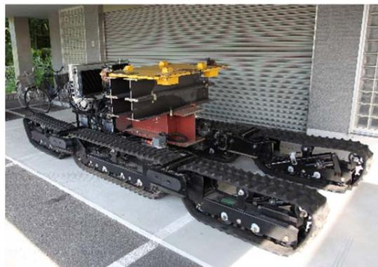
Photo 4 開発したロボットの走行装置
