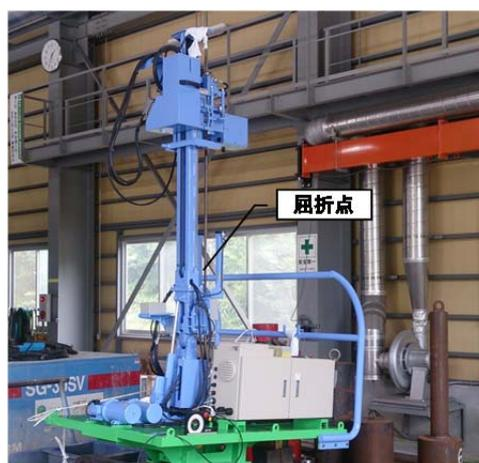
Photo 5 ロボットに搭載する貫入試験装置
