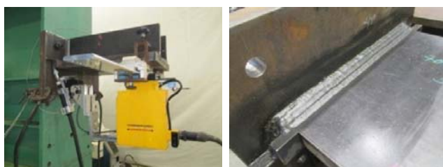
(1) ロボット設置 (2) 溶接ビード外観(T-40 タイプ)
