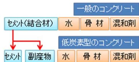
Fig. 2 コンクリートの材料構成のイメージ
