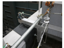
c) ウィンチ機構 Winch-System
