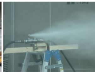
Photo 7 散水ノズル Sprinkling Nozzle
