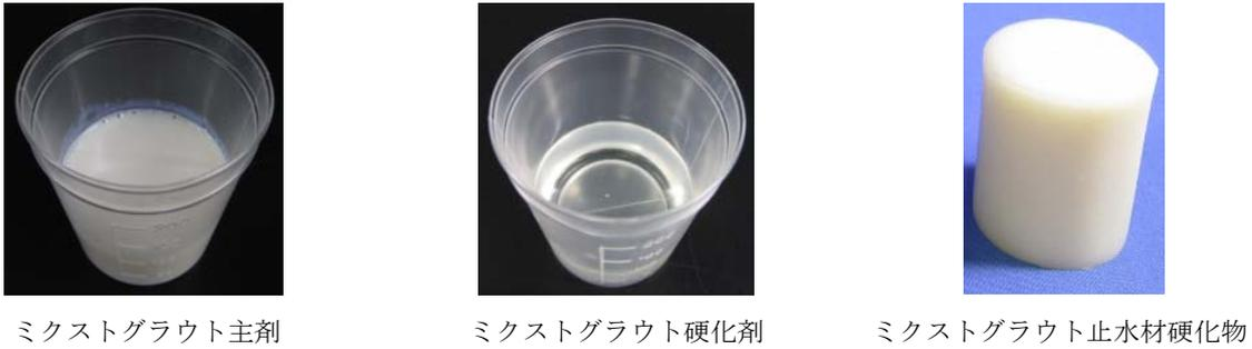
Photo 3 ミクストグラウト止水材の構成材料および止水材硬化物外観
