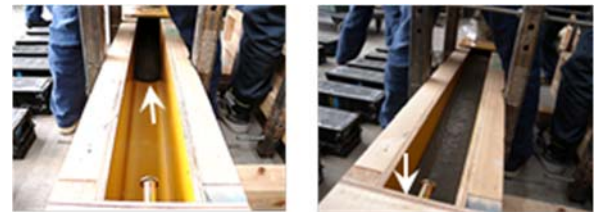
(a) 打込み開始後20秒 (b) 打込み開始後70秒 (矢印はスリムクリートの到達位置を示す)
