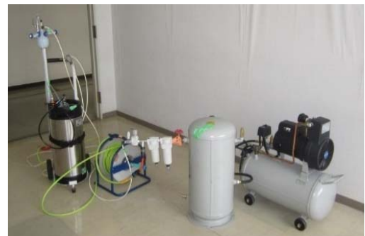
Photo 3 可搬型マルチミスト Portable Multi Mist
