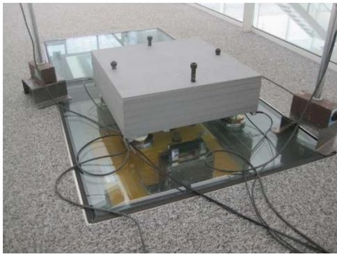
Photo 1 低コスト型TMDの実証実験
