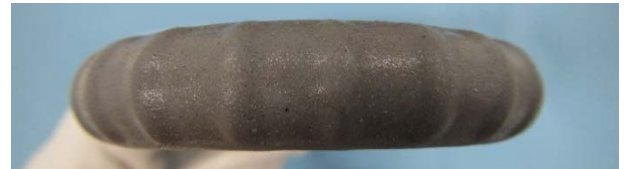
Photo 2 塩水噴霧試験後(曲げ試験後)の状況 Result of Salt Spray Test (Bending Test)
