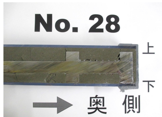
Photo 16 No. 28の先端におけるモルタル充填状況 (空気量：0.6%，簡易フロー：73mm) Grout Condition at the Tip of the No. 28 (Entrapped Air: 0.6%, Flow Value: 73mm)
