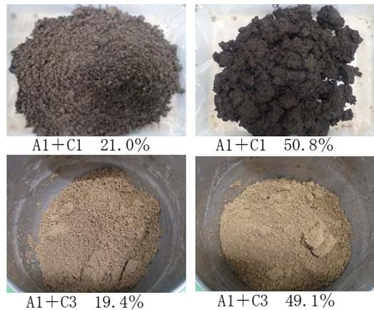
Photo 1 混合後の試料の状況
