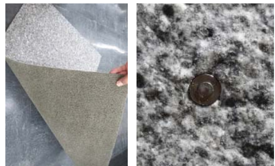
Photo 2 石材調シート材およびアンカーピン Stone-like Decorative Fabric and Anchor Pin
