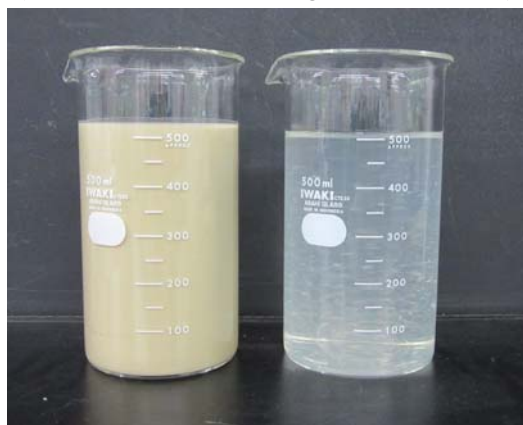
Photo 3 安定液②の処理水の状況(室内撮影) (左：凝集剤添加前，右：凝集剤最適値)
