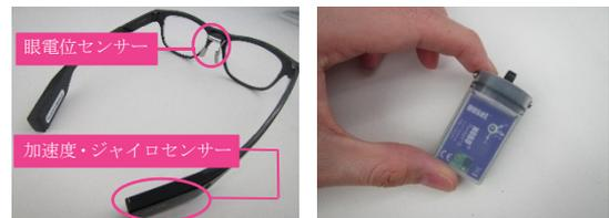
Photo 2 左：集中度計測機器 右：傾斜計
