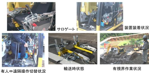
Fig.5 遠隔操縦装置「サロゲート」
