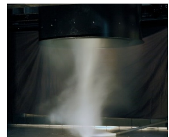
Photo 6 竜巻発生装置 Tornado Generator
