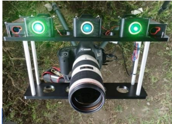
Photo 5 レーザ光照射システム Laser Irradiation System
