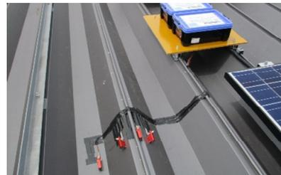
(1) 熱電対による上折板の温度計測
