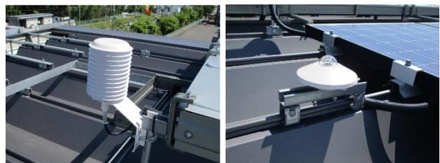
(2) 温度計による外気温度計測 (3) 日射計による日射量計測
