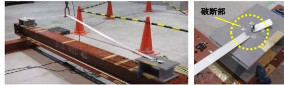
Photo 3 破断状況
