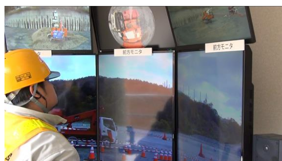
Fig. 13 試験状況(5Gによる遠隔操縦) Test Status (5G Remote-Control)
