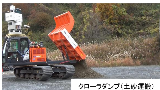
Fig. 13 試験状況(5Gによる遠隔操縦) Test Status (5G Remote-Control)
