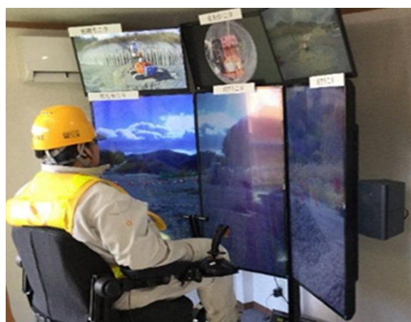
Photo 1 遠隔操縦席 (6面モニタ, ステレオ音響再生, 座席振動機構) Remote Cockpit
