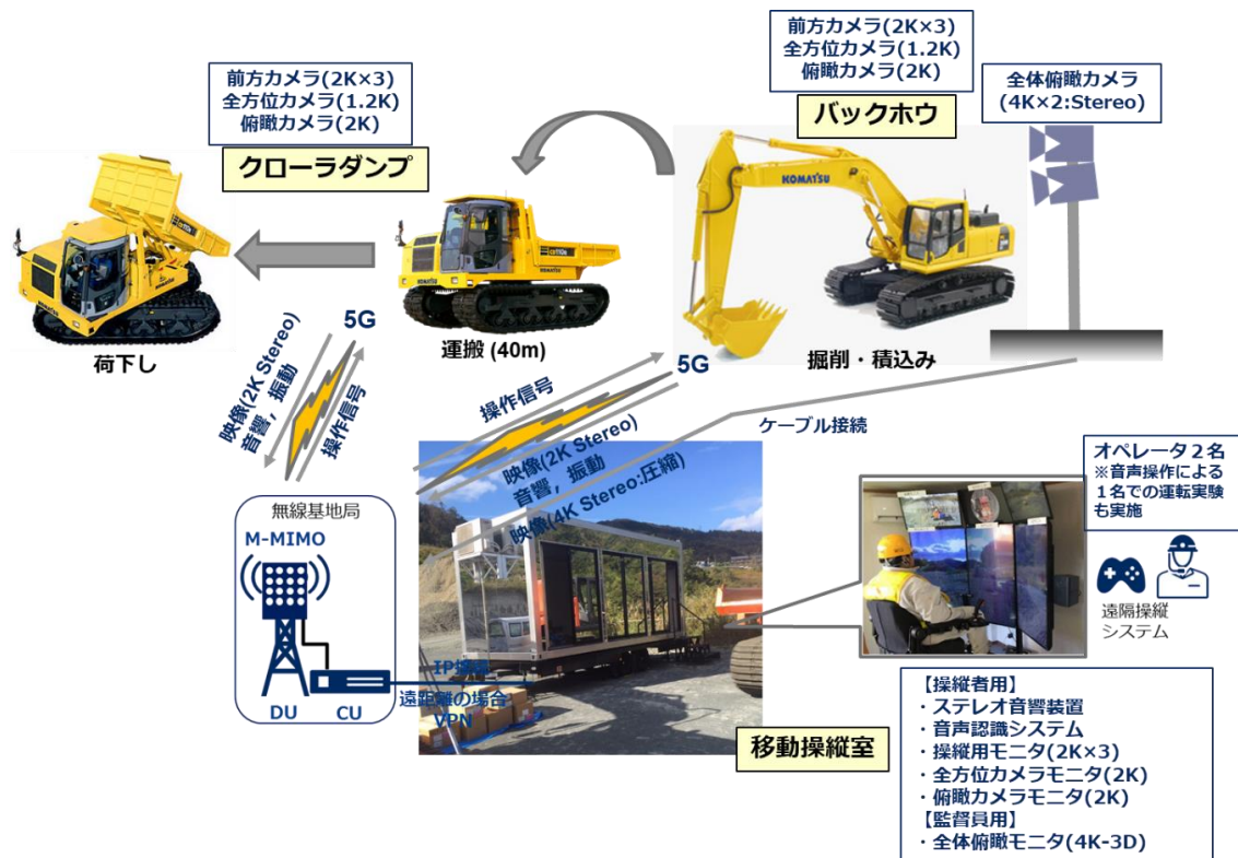
Fig. 5 試験の機器構成 Test Equipment Configuration
