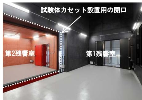
Photo 12 残響室内部と試験体カセット設置用の開口
