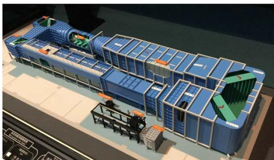
Photo 5 風洞装置(模型)
