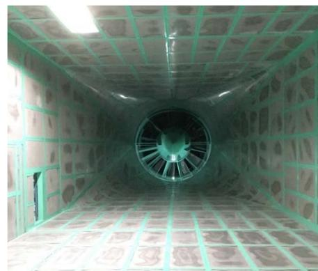
Photo 7 風路内の吸音材の設置状況
