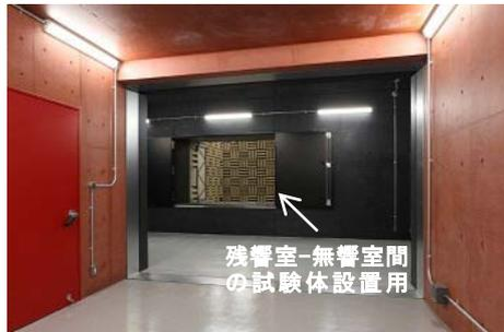
Photo 17 残響室および無響室の試験体設置用開口
