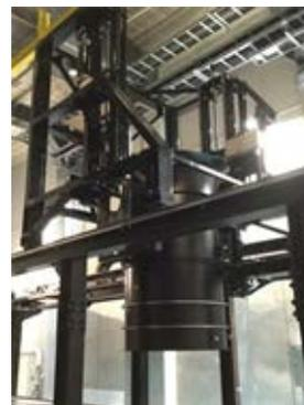
Photo 9 ダウンバースト発生装置
