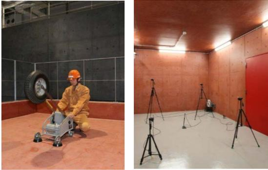
Photo 14 スラブ加振による測定
