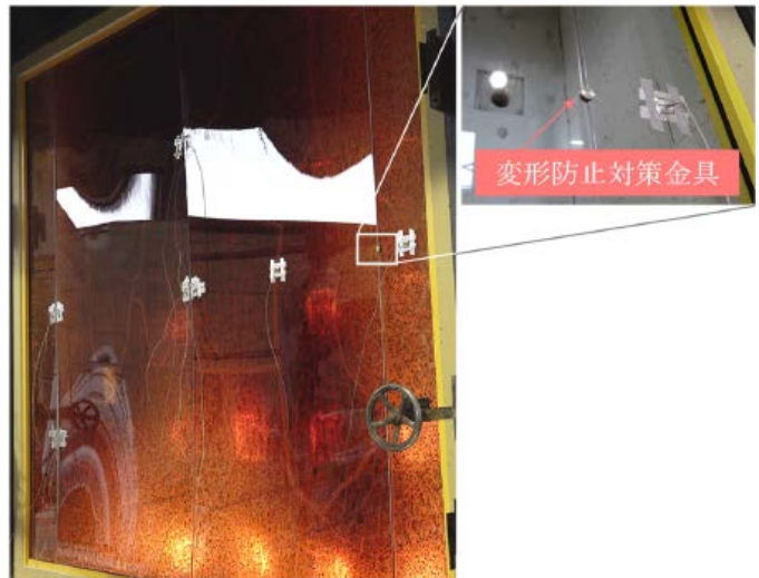
Photo 6 10分間の加熱を受けた連装ガラスパーティション Continuous Glass Partition after 10 Minutes Heating
