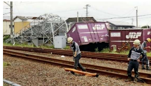
Photo 4 竜巻で飛ばされたコンテナと倒れた鉄塔(宮崎・JR延岡駅構内, 読売新聞社撮影)
