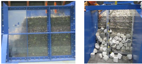
(c) Case3-2(背面部巻込み(縦筋)) : 中崩壊
