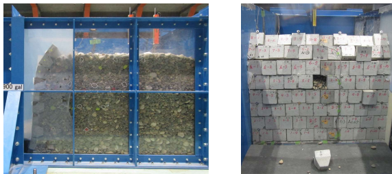
(e) Case5-2(壁面材+アンカー) : 落石1個
