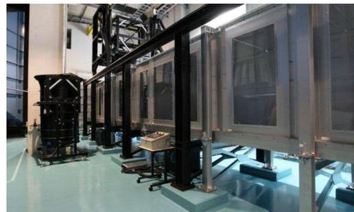
Photo 2 マルチファン型非定常気流風洞装置
