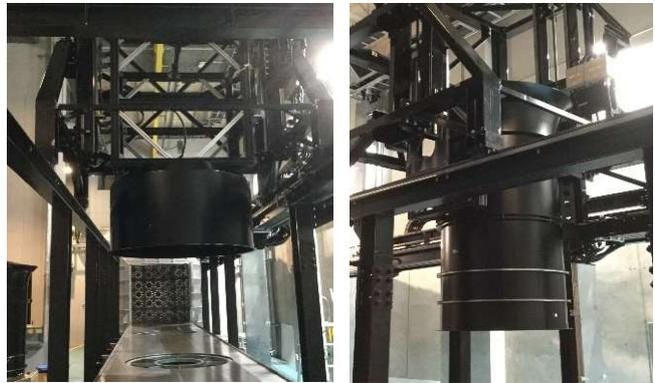
(a) 竜巻発生装置 (b) ダウンバースト発生装置
