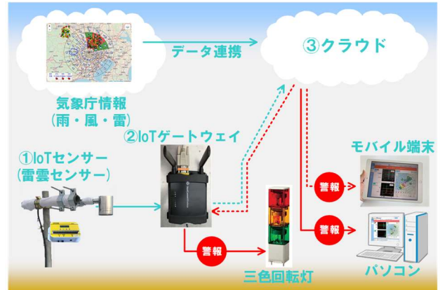
Fig. 1 システム構成図 System Configuration
