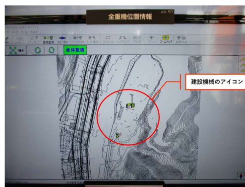
Fig. 13 遠隔施工管理操室内での全建機の位置情報 Position Information of All Construction Machines in the Remote Cockpit
