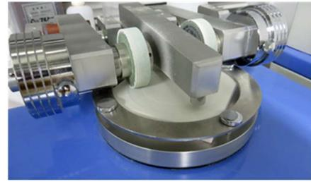
Photo 3 耐摩耗性試験状況
