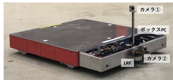
Photo 3 センサーユニットを追加したAGV Low-Flatbed AGV with Sensor Unit
