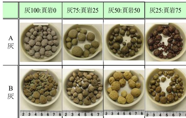
Photo 2 焼成骨材の外観
