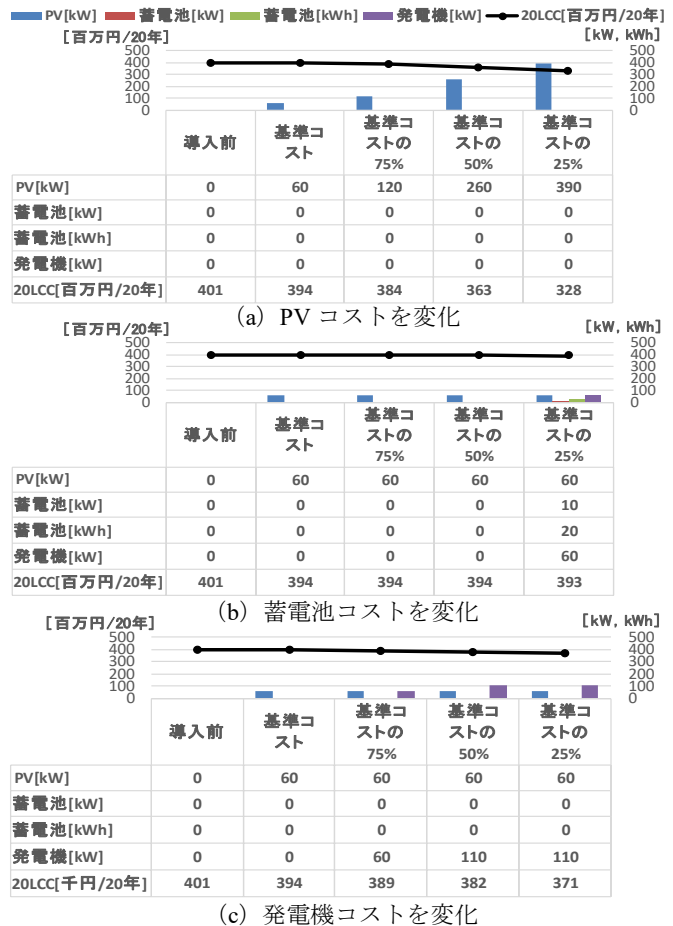
Fig. 3 コスト設定による分散型電源容量算定結果への影響（20年間のライフサイクルコスト最小）
