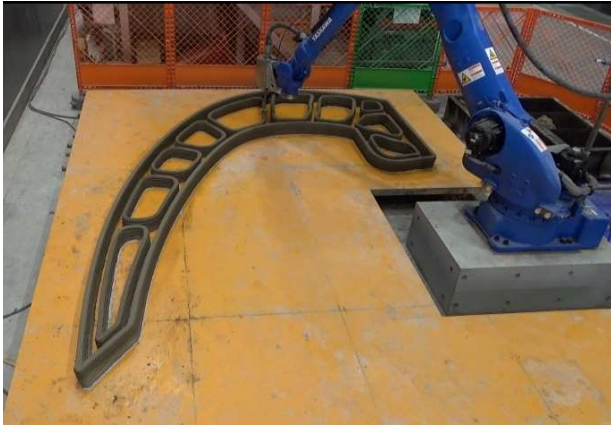
Photo 7 3Dモルタルの積層状況（開始直後） Printing of 3D Mortar (at Start)
