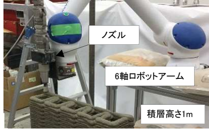
Photo 1 試験体の製造状況 Printing of Test Piece
