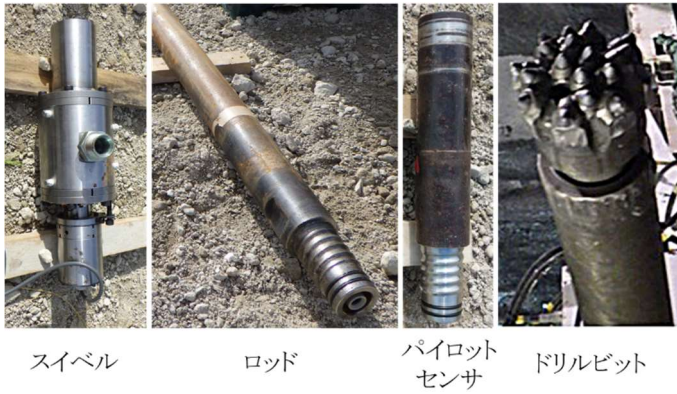
Fig. 5 削孔機械に取り付けるデータ送信装置 Devices for Acquisition of the Pilot Signal
