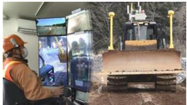
Photo 4 ローカル5Gを用いた重機の遠隔操縦実験
