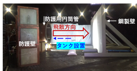
Fig. 1 実験装置概要 Layout of Explosion Tests
