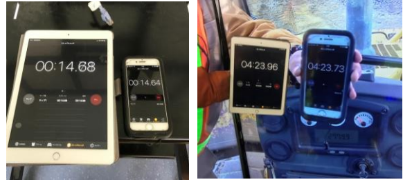
(左：遠隔操縦室での計測開始 右：遅延計測状況)
