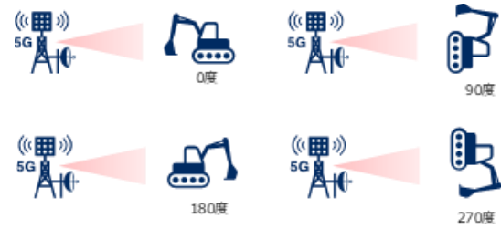
Fig. 3 基地局に対する油圧ショベルの向き Direction of Excavator with Respect to Base Station
