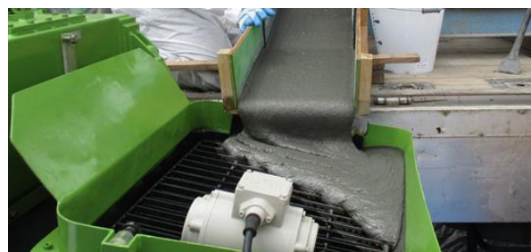
Photo 1 モルタルの排出状況 Mortar Discharge
