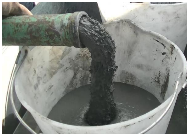
Photo 2 鋼繊維のファイバーボールの発生状況 Fiber Ball of Steel Fiber
