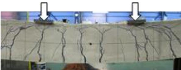
Photo 6 曲げ破壊型試験体の破壊状況
