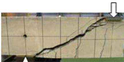
Photo 7 せん断型試験体の破壊状況
