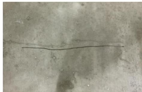
Photo 9 発生したマイクロクラック Microcrack in Surface of Slim-Crete
